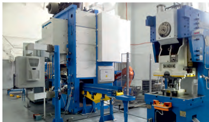
Robotizovaná linka / Robotized line LMZ 1000 + S160 + rotační (karuselová) plynová pec / LMZ 1000 + S160 + rotational (carousel) gas furnace
